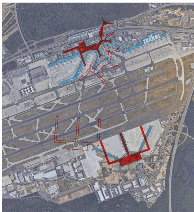
Figur 3.2 Jämförelse av terminalkropp och avstånd mellan terminalbyggnader för Frankfurt Airport (blå figur) och Arlanda 2070 (röd figur)
